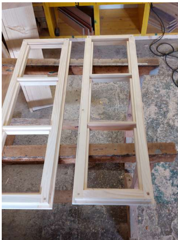
033 výroba kópii futra okna a nových okenných krídel
