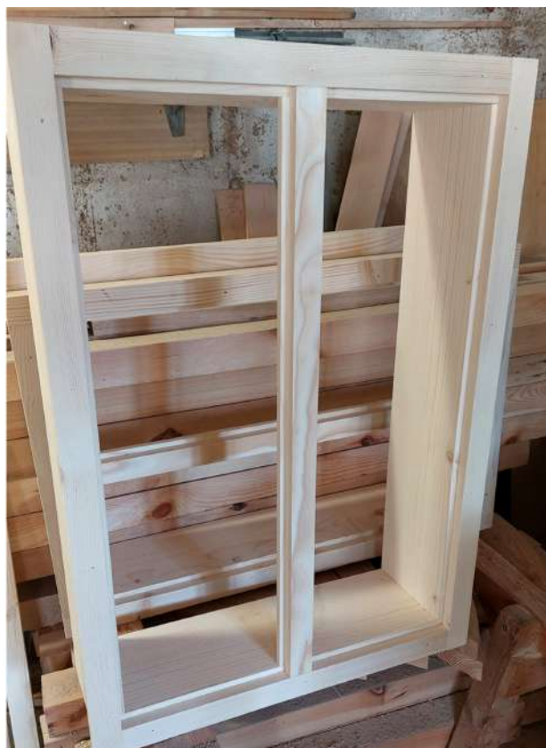
033 výroba kópii futra okna a nových okenných krídel
